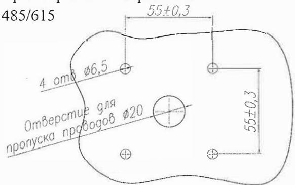
Рис.2 Расположение монтажных отверстий на турникете
