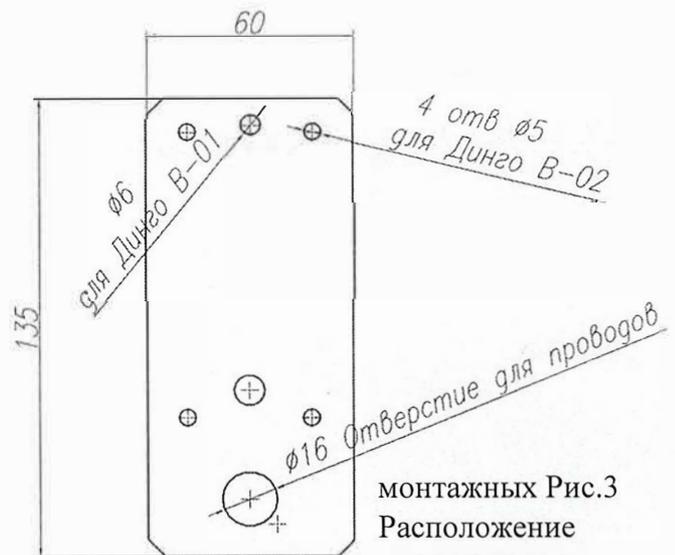
Рис.3 Расположение монтажных отверстий для крепления индикатора
